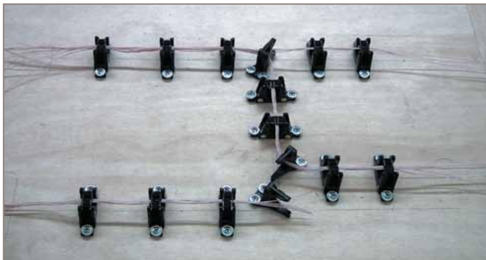
Рис. 2. Первый фанерный плаз с применением держателей, собранный АО «МКБ «Факел»
