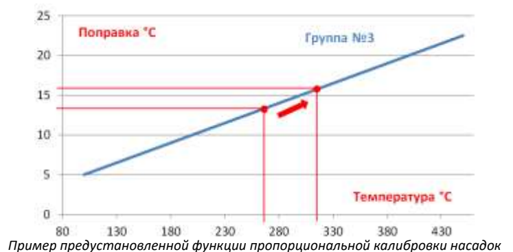
Пример предустановленной функции пропорциональной калибровки насадок
