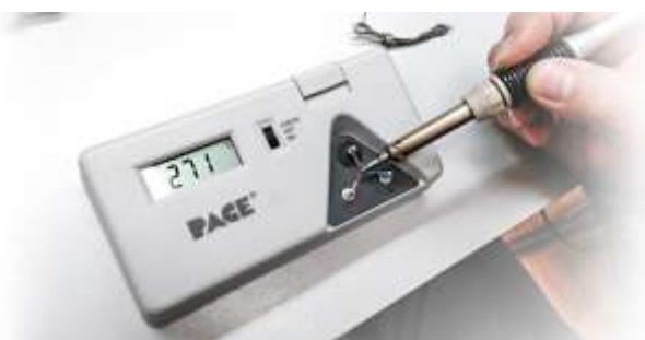
Точная температурная калибровка паяльной насадки
