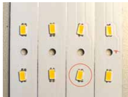
Рис. 9. После установки светодиоды намеренно сдвинуты со своих контактных площадок Только светодиод в красном круге не встанет на свое место при пайке
