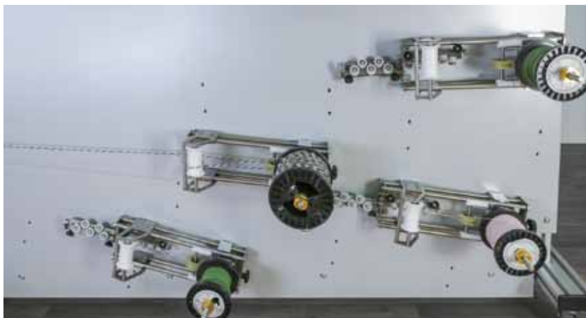
Рис. 2. Система подачи провода с катушек или бухт
