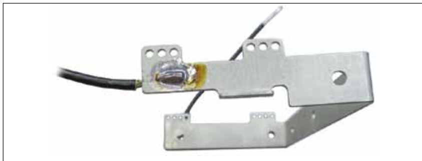
Рис. 12. Припаянный провод 6 мм 2 к медной шине
