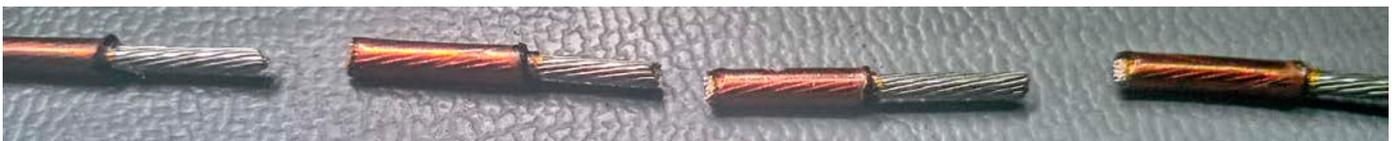
**Вывод:** Использование системы ФРЦ-150 позволяет значительно упростить процедуру снятия изоляции, при этом не оказывая вредного воздействия ни на жилы провода, ни на здоровье монтажника. Повторяемость результата - хорошая.
