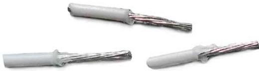
Для снятия изоляции наиболее подходит режим с длительностью импульса 1.2с при мощности 25%. Следов расплавленной изоляции и следов нагара на жилах нет, их цвет не изменен, жилы не повреждены. Изоляция в месте снятия немного оплавляется и незначительно меняет форму. Повторяемость результата - очень хорошая.
